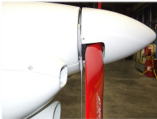
Abbildung 5: Befestigungspunkt zwischen Cowling und Propellerspinner
