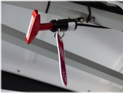
Abbildung 7: Auslösegriff mit Sicherheitspin
