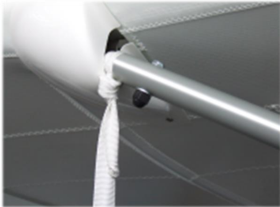
Abbildung 4: oberer Befestigungspunkt an vorderer Flächenstrebe
