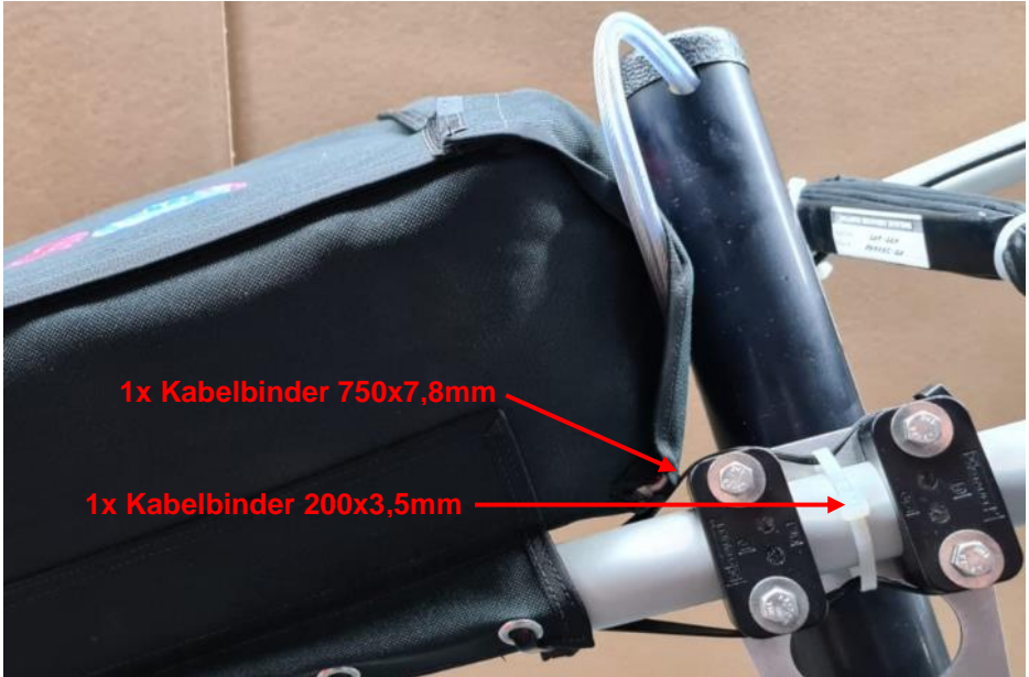
Abbildung 11: Befestigungspunkte Kabelbinder BRS-6-1050-SP
